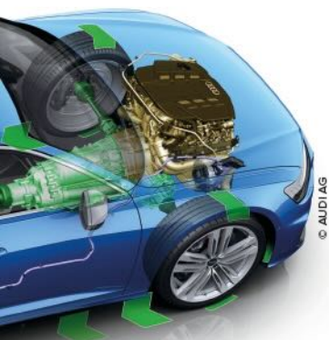
La ilustración muestra el flujo de energía de un vehículo híbrido ligero
